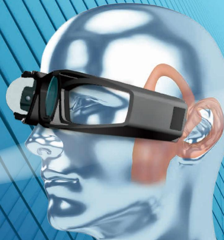
リアルタイムで「眼球運動画像」「眼振図」「頭の傾き」を同一画面内に表示することで、めまい検査をサポートします。角度グラフ、速度グラフは3次元表示(水平、垂直、回旋)が可能です。
