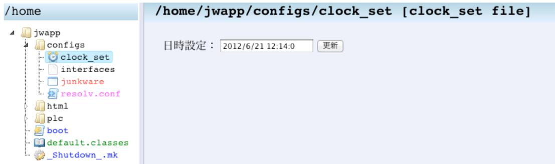
PLC-FARMにはRTCが搭載されていて、バッテリーバックアップされています。カレンダータイマの時刻合わせをする時には、JWTの左側ツリーのconfig/にあるclock\_setをクリックしてください。右側ペインに上図のような時刻設定画面が表示されるので、「更新」をクリックすると、PLC-FARMに時刻がセットされます。なお、clock\_setをクリックした時に表示される時刻はローカルパソコンの時刻になります。
